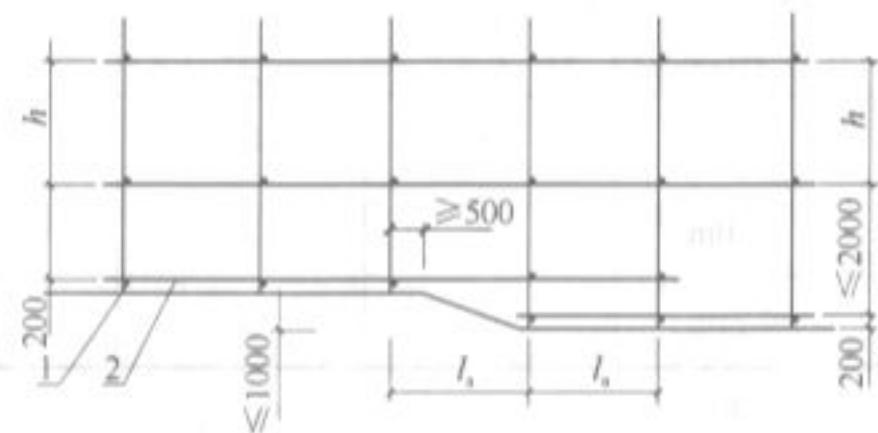
图 6.3.3 纵、横向扫地杆构造
