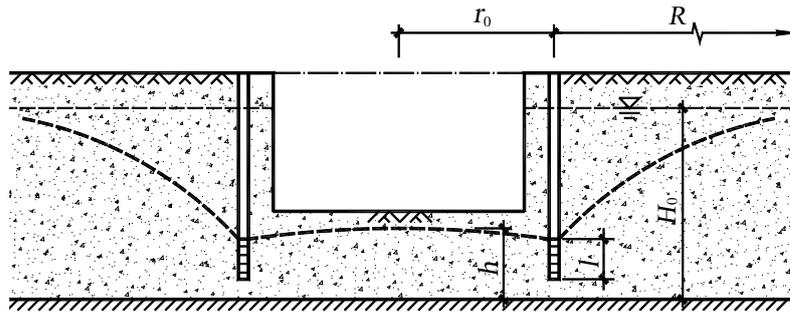
图 E.0.2 按均质含水层潜水非完整井简化的基坑涌水量计算
