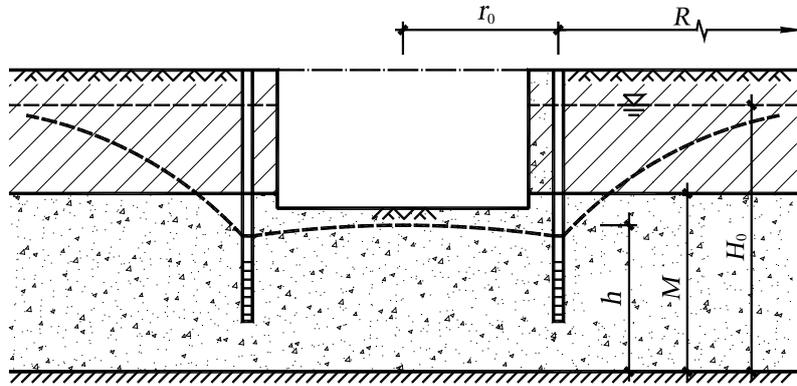
图 E.0.5 按均质含水层承压~潜水非完整井简化的基坑涌水量计算
