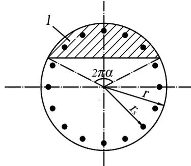
图 A.0.1 沿周边均匀配置纵向钢筋的圆形截面
