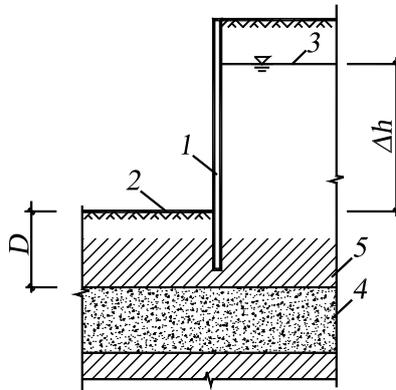
图 C.0.1 坑底土体的突涌稳定性验算
