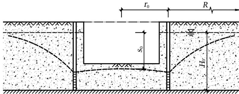
图 E.0.1 按均质含水层潜水完整井简化的基坑涌水量计算
