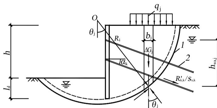
图 4.2.3 圆弧滑动条分法整体稳定性验算
