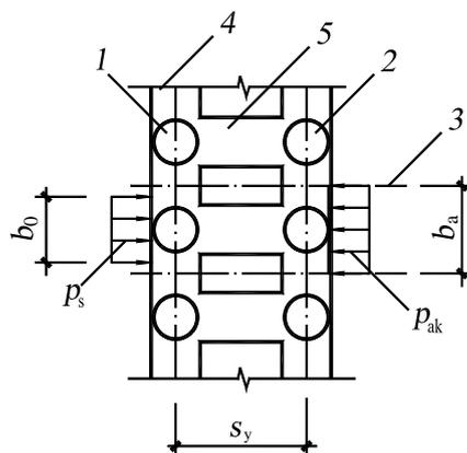
图 4.12.1-2 双排桩桩顶连梁布置
