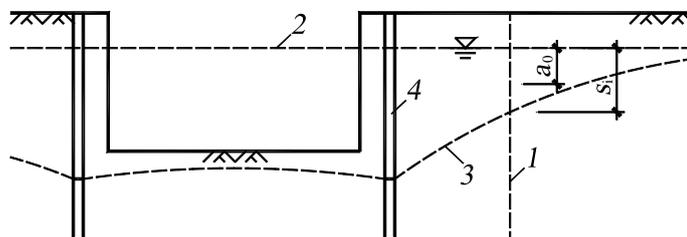
图 7.5.2 降水引起的附加有效应力计算
